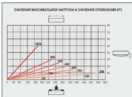
Монтаж лотков шириной не более 300 мм можно производить с использованием крепления АТ-3. Данный вариант предусматривает, как крепление через потолочный элемент “U” код 3000001, так и на прямую через стальной анкер. **Расстояние между опорами не должно превышать 1,5 м.**
